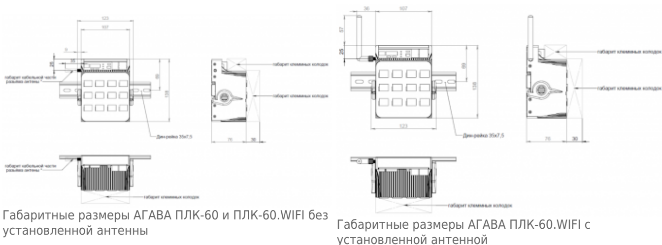
Рисунок 2 - Габаритные размеры АГАВА ПЛК-60.WIFI с установленной антенной
